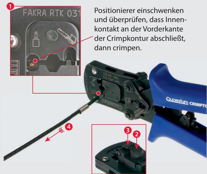
Positionierer einschwenken und überprüfen, dass Innenkontakt an der Vorderkante der Crimpkontur abschließt, dann crimpen.
